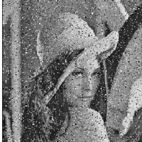
Fig. 5.1: Imagine afectată de zgomot impulsiv; 10% dintre pixeli au valorile modificate
